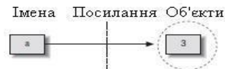
Рис. 5.1. Імена та об'єкти після виконання операції присвоєння a = 3 . Змінна перетворюється на посилання на об'єкт «3», у внутрішньому поданні змінна є вказівником на простір пам'яті з об'єктом, створеним в результаті інтерпретації літерального виразу «3»
