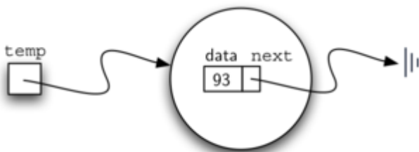
Малюнок 3: Об'єкт Node , що містить значення та посилання на наступний вузол
