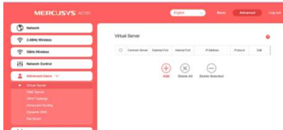
Рис. 2.24. Переадресування у роутері Mercusys AC12g
