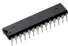
Рис. 1.1. Мікроконтролер ATmega328P
