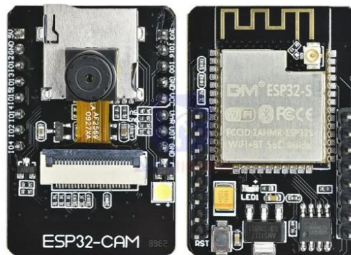
Рис. 3.6. Модуль ESP32-CAM
