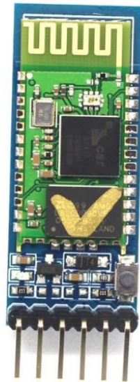
Рис 1.5. Модуль Bluetooth HC-05
