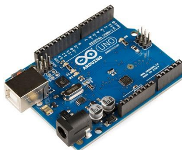
Рис. 1.2. Контролер Arduino Uno
