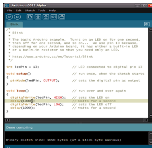
Рис. 2.18. Arduino з прикладом простої програми
